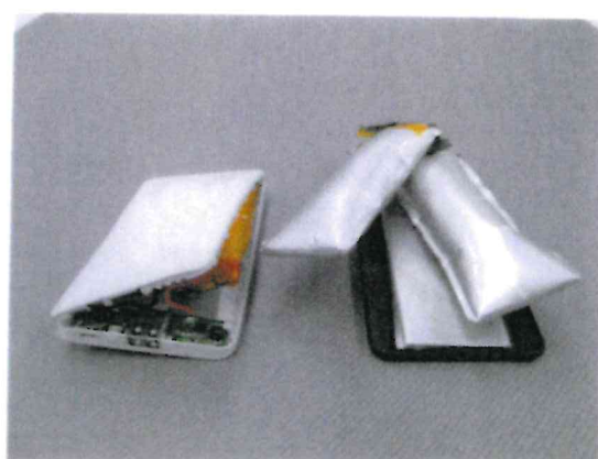
さらに膨張して外装が外れる
