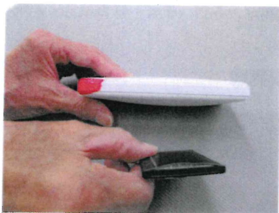
内部が膨張して外装が膨らむ
